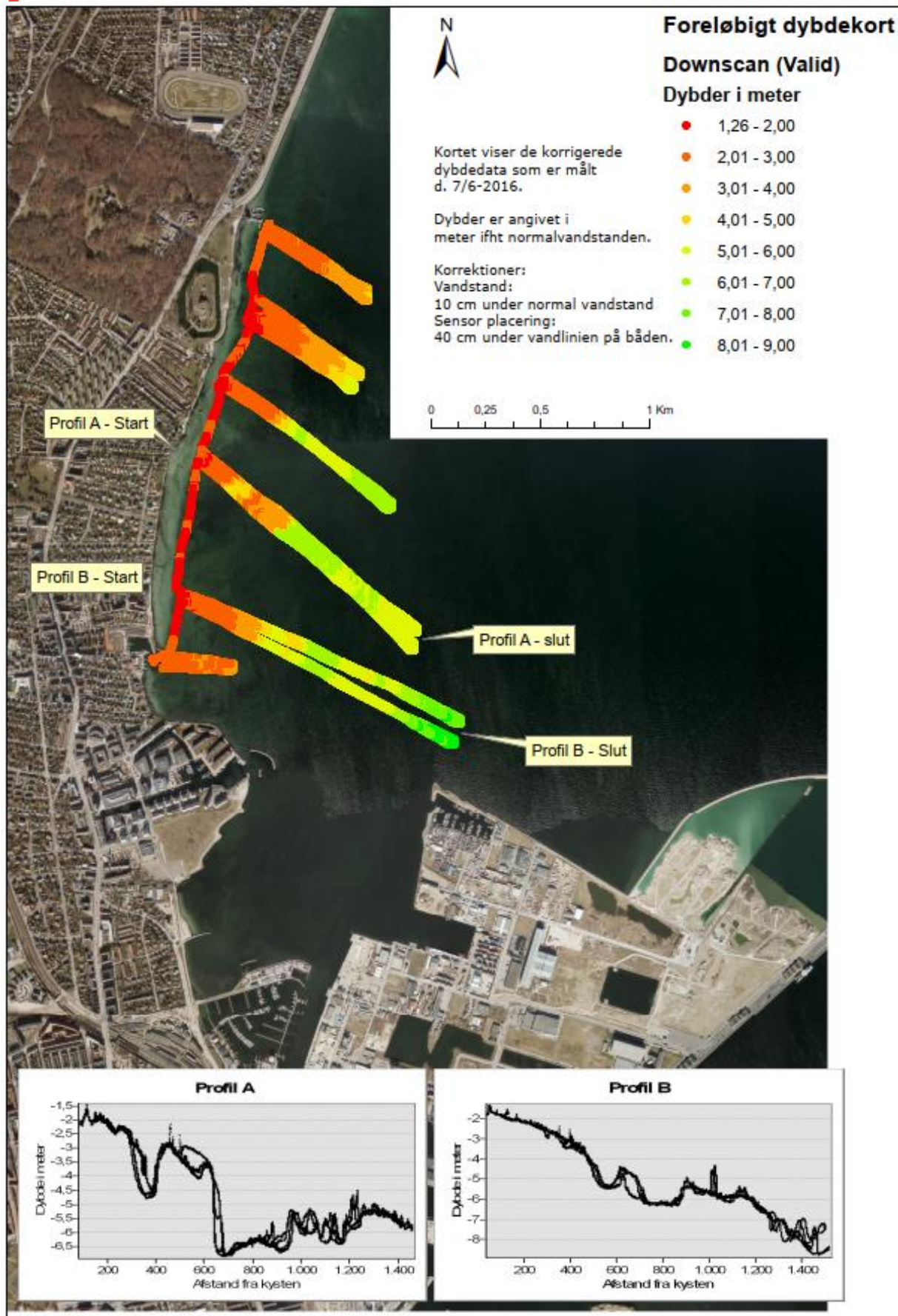
Figur 4-4. Dybdekort lavet ud fra pejling den 7. juni 2016 af havnefogeden i Gentofte Kommune. De to grafer viser dybdeprofilerne for transekterne/profilerne A og B.
