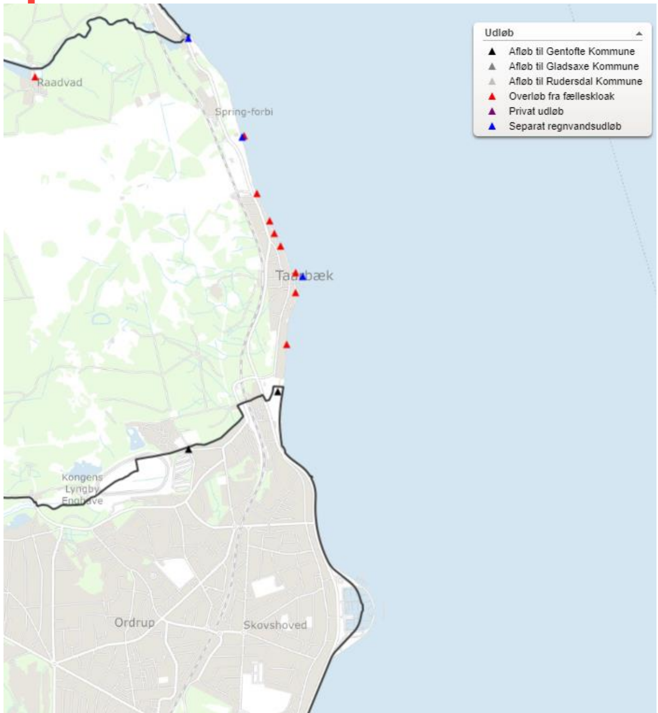
Figur 2-43. Oversigt over udløb og overløb til Øresund tæt på Gentofte Kommune fra Lyngby-Taarbæk Kommune. Kort hentet fra Lyngby-Taarbæk Kommunes Kommuneplan 2021 ( Kommuneplan 2021 (Itk.dk) ). De blå trekante repræsenterer udløb med regnvand og de røde trekante repræsenterer spildevandsoverløb.
