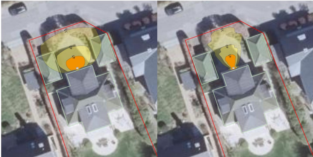
Figur 5: Støjberegning for en gennemsnitlig varmepumpe (60 dB) ved maksimalt støjniveau i Energistyrelsens støjberegner. Til venstre illustreres støjberegning uden støjafskærmning og til højre med støjafskærmning.
