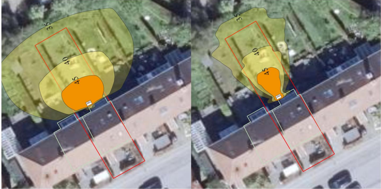
Figur 9: Støjberegning for en støjende varmepumpe (65 dB) ved maksimalt støjniveau i Energistyrelsens støjberegner.
