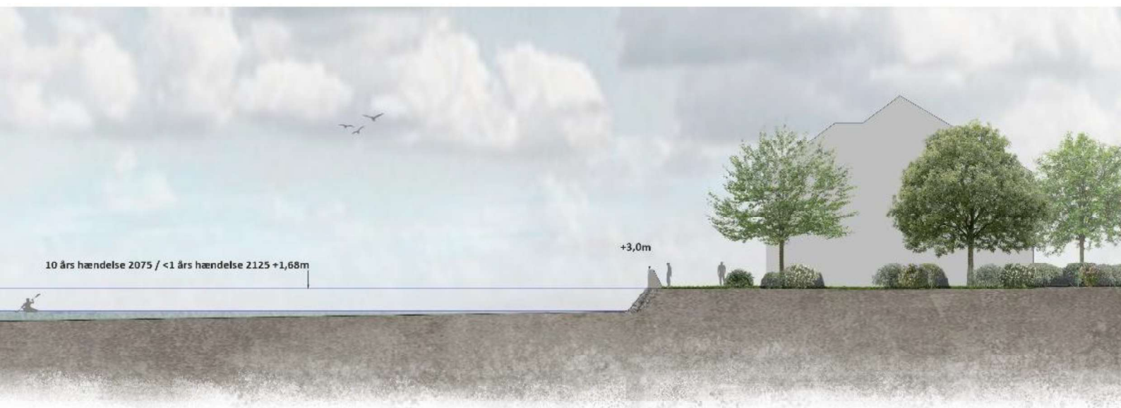
Figur 4-1 Type 01 - Forhøjelse af eksisterende mure, principsnit. Bemærk, at murene ikke vil kunne beskytte til det anbefalede sikringsniveau.
