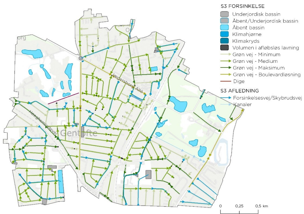
Figur 29 Plan for overfladesystem for scenarie S3, samt dele af det underjordiske system
