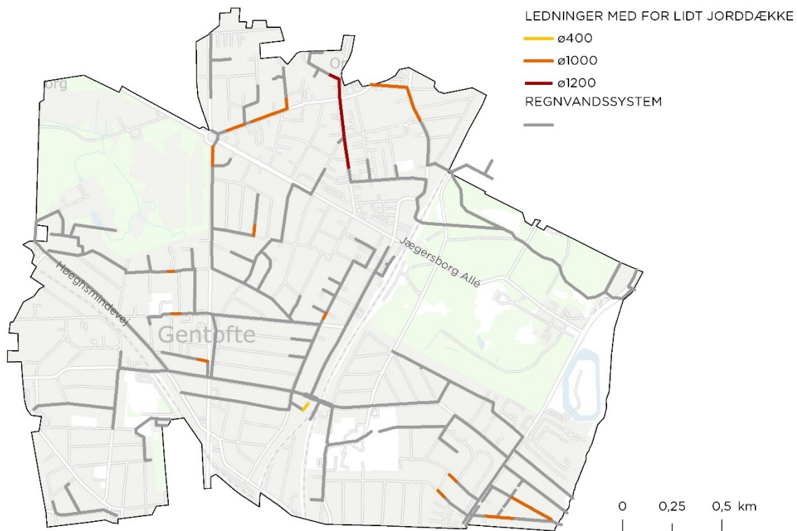
Figur 79 Ledninger i regnvandssystemet, som i den hydrauliske model for serviceniveau S3 er indlagt med et jorddække, som er mindre end anbefalet. Grå linjer indikerer resterende system.
