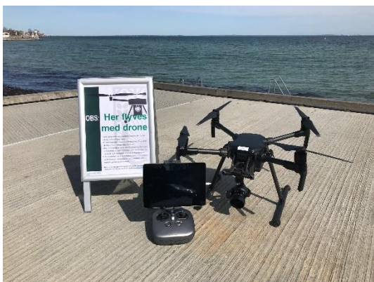
Fra venstre mod højre: 1) Skilt, som oplyser forbipasserende om igangværende aktivitet, 2) Styreenhed, hvor dronepilot kan følge drone på tablet og 3) Drone.
